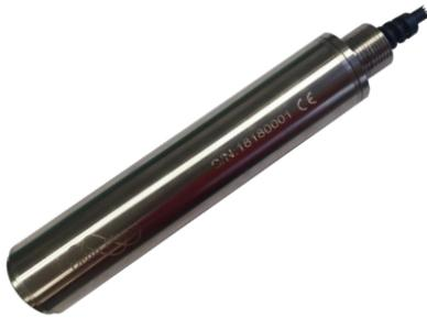
**OW水中油传感器**采用荧光法对水中油的浓度进行测量，通过闪烁氙光源带滤光片发射254nm光照射水体，激发溶解入水体中的芳香族碳氢化合物产生特定波长的荧光，即可测得水中油的浓度。
